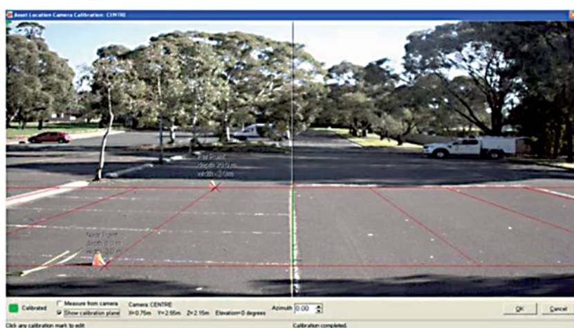
Figura 31. Câmpul vizual al camerei care prezintă planul de calibrare (calibrarea de distanță)
